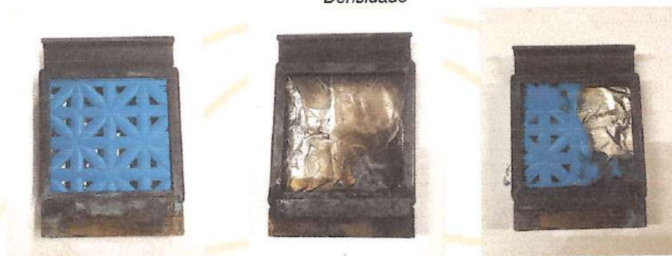
Antes / Após sem chama e com chama
