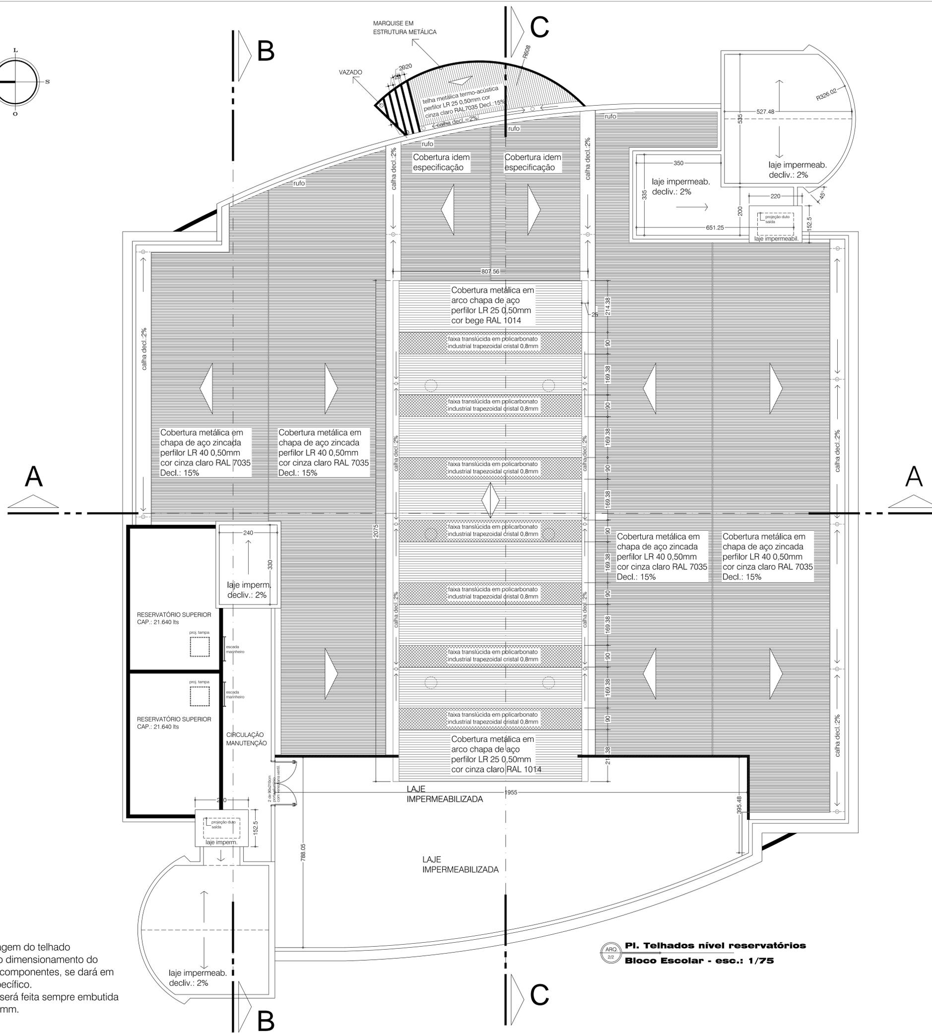
OBS.: A estrutura de montagem do telhado será metálica, onde o dimensionamento do mesmo, bem como, componentes, se dará em projeto estrutural específico. A descida do pluvial será feita sempre embutida em pilares com Ø 75mm.
